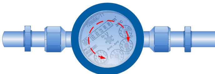
Vízmérő forgatható számlappal
