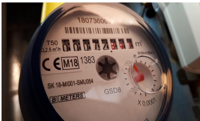
A képen a bekeretezett „M” metrológiai jelet követően 18 a 2018 évi hitelesítést jelöli.
